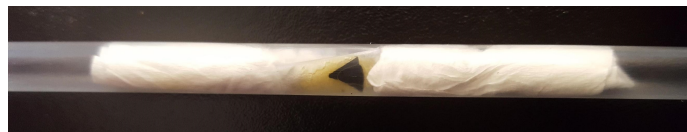
FIGURE 3.5 Monocristal \text{TmMnO}_3 orienté selon son axe [118] dans une paille pour être introduit dans l'appareil SQUID. L'échantillon est maintenu en place par une touche de graisse Apiezon N.
