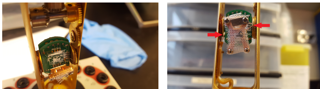
FIGURE 5.13 Photographies du montage brisé. Un des fils de retenue s'est brisé lors d'une rotation, résultant en la chute du porte-échantillon.
