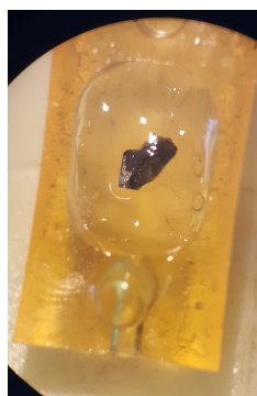
FIGURE 3.6 Monocristal \text{HoMn}_2\text{O}_5 orienté selon son axe difficile dans un prototype d'étui fait d'Ultem TM pour être introduit dans l'appareil SQUID. L'échantillon est maintenu en place avec de la graisse Apiezon N ainsi que du coton.
