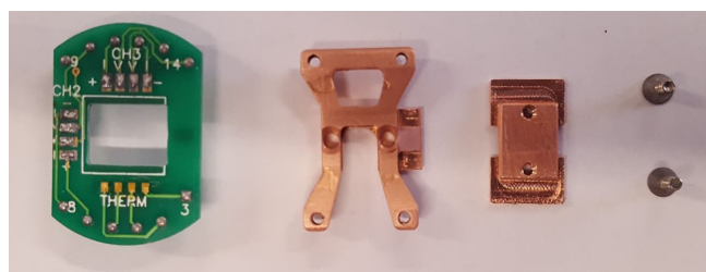
FIGURE 3.21 Troisième itération de porte échantillon qui est encastré dans la puce. (De gauche à droite) la puce modifié, partie supérieur de la base, partie inférieur de la base, vis 0-80.
