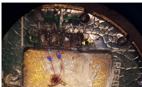
FIGURE 3.9 Photographie d'un thermomètre, encadré rouge, installé sur une rondelle de mesure standard et les fils, représentés par les lignes rouges, sont soudés aux contacts d'or d'un des canaux. Les différents canaux servent à injecter un courant et à mesurer la tension dans un échantillon qui lui est soudé, ceci en fonction de la température.
