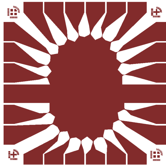
(b) Masque de gravure pour du PCCO. Définition des jonctions de 5 et 20 \mu\text{m} .
