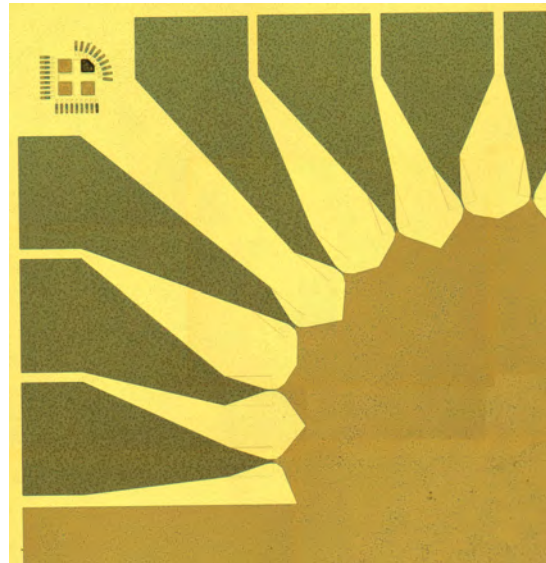
(d) Jonctions Josephson complétées suite à la dernière gravure du PCCO. Jonctions de 5 et 15\mu\text{m} .
