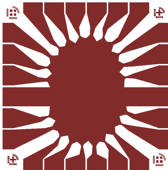
(c) Masque de gravure pour du PCCO. Définition des jonctions de 50 et 100 \mu\text{m} .
